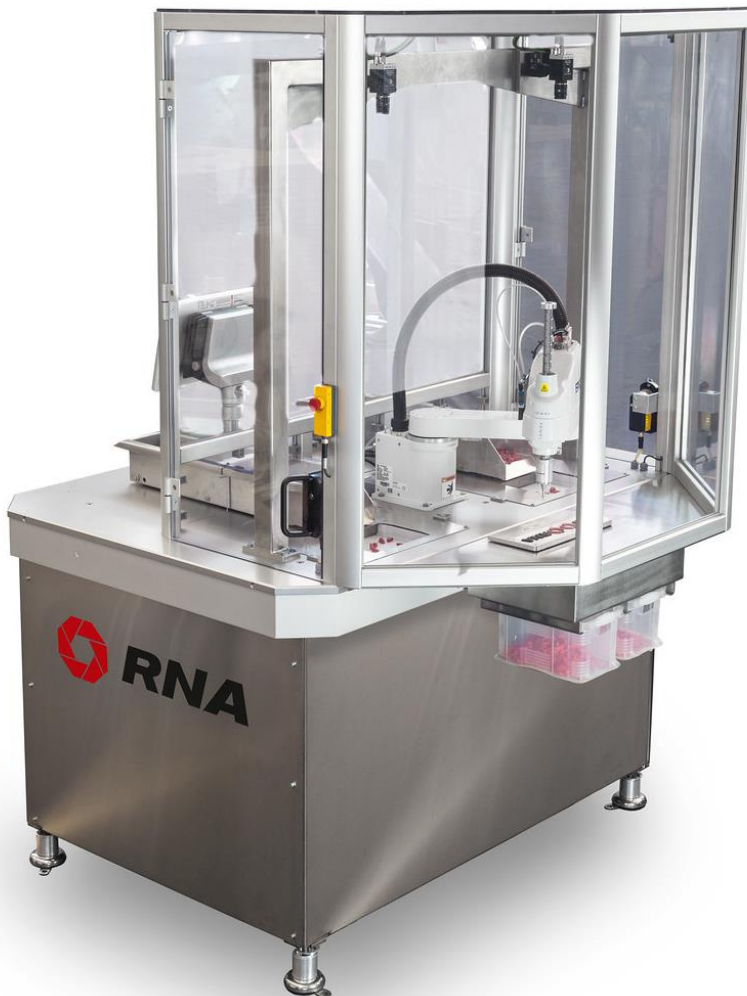
Asycube 530 flexible Zuführplattform von Asyri für Teile von 30-150mm Grösse
